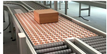
여기에 새로운 이중 교차 스위치가 있습니다. (이미지 2 및 3 참조). 운송할 가장 큰 화물에 따라 폭과 길이가 유연합니다. 일직선으로 일직선을 이루든 대각선 한 선에서 다른 선으로 교차하든 양방향으로 상품을 이동합니다. 속도는 0.3ms 에서 1.5ms 까지 조정 가능합니다. 롤러 피치는 75mm 또는 37.5mm 입니다.
